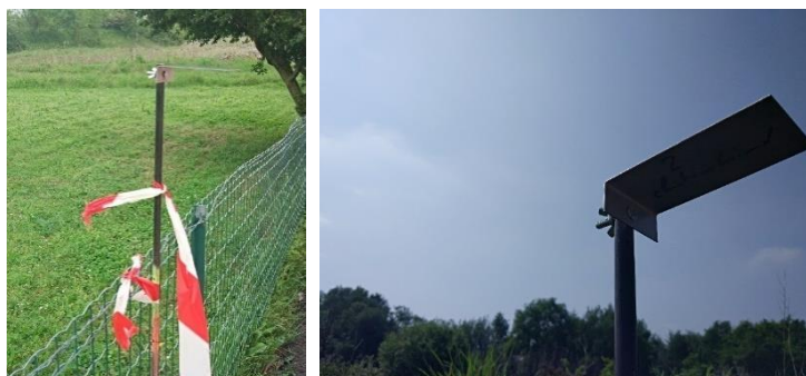
FIGURE 4.1 : Dispositif de prélèvement de type plaquette de dépôt
